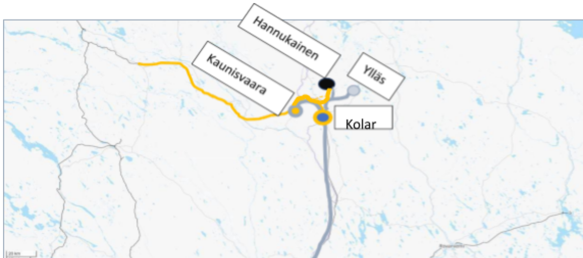
Kuva 13: Molemmat raideleveydet Kolarin ja Kaunisvaaran raja-asemien välillä sekä Hannukaisen kaivoksen menevälle teollisuusraiteelle. Tunturiradan luonnollinen jatke on Kolarin ja Ylläksen matkailukeskuksen välinen rata.
